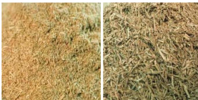
**Abb. 6** Typische Holzpartikel für Spanplatten,
