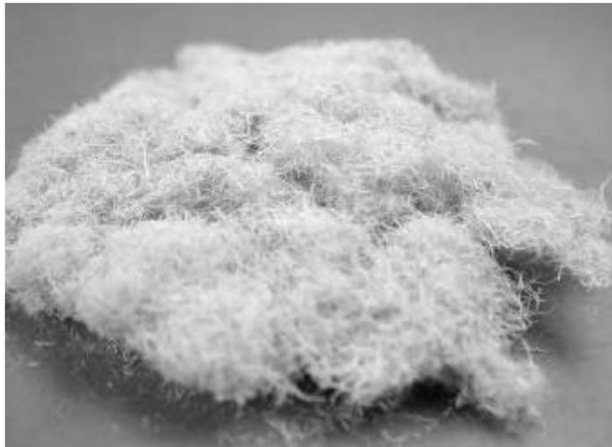
**Abb. 9**                      MDF Faserstoff aus entrindetem Fichtenholz
