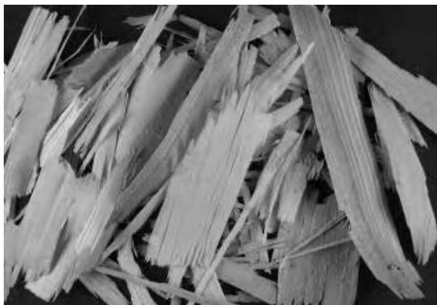
**Abb. 7** Strands zur Herstellung von OSB
