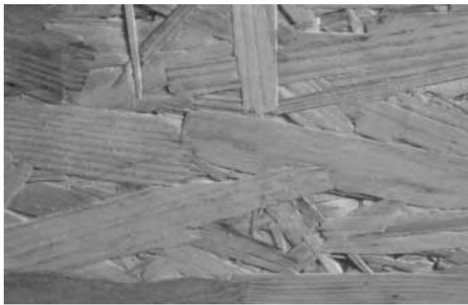
**Abb. 8** Oberfläche einer OSB, deutlich ist die Strandorientierung zu erkennen
